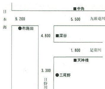
九頭竜川計画高水流量図 (単位 \text{m}^3/\text{sec} )
