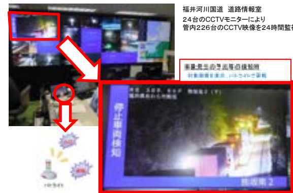
停止車両を検知した場合、モニター表示とアラームで通知
