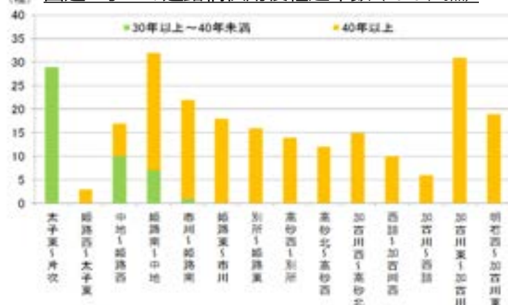
国道2号BPの道路橋供用後経過年数 (2018年時点)
