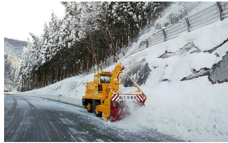
除雪トラックによる除雪状況
