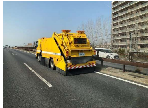
路面清掃状況
