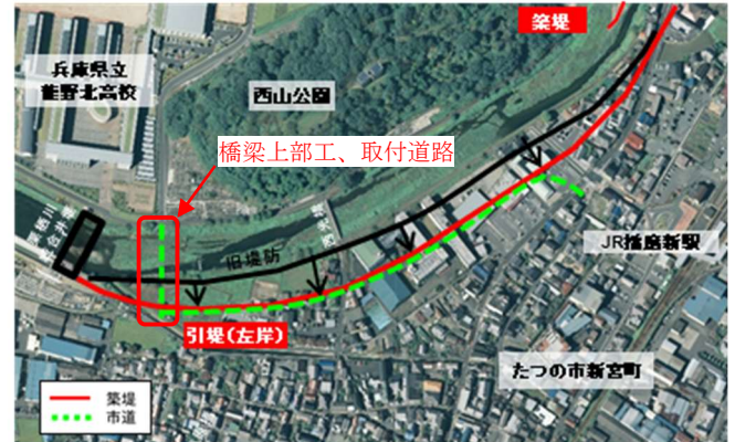
築堤・橋梁架替箇所(新宮他地区)
