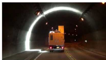
走行型計測車両による 供用前トンネル調査
