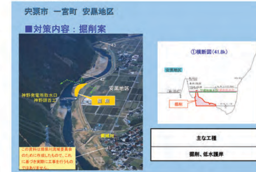
図10 掘削案のみの例
