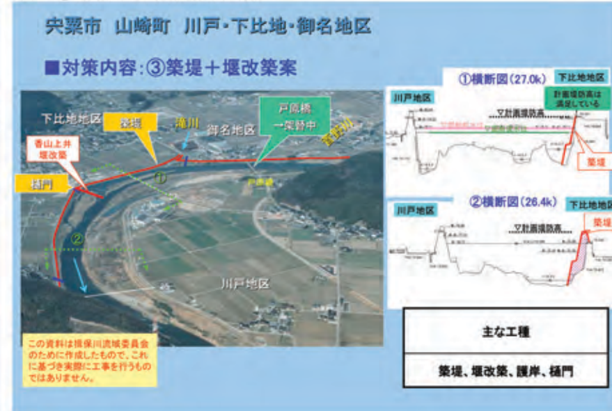
図6 ③築堤+堰改築案の内容
