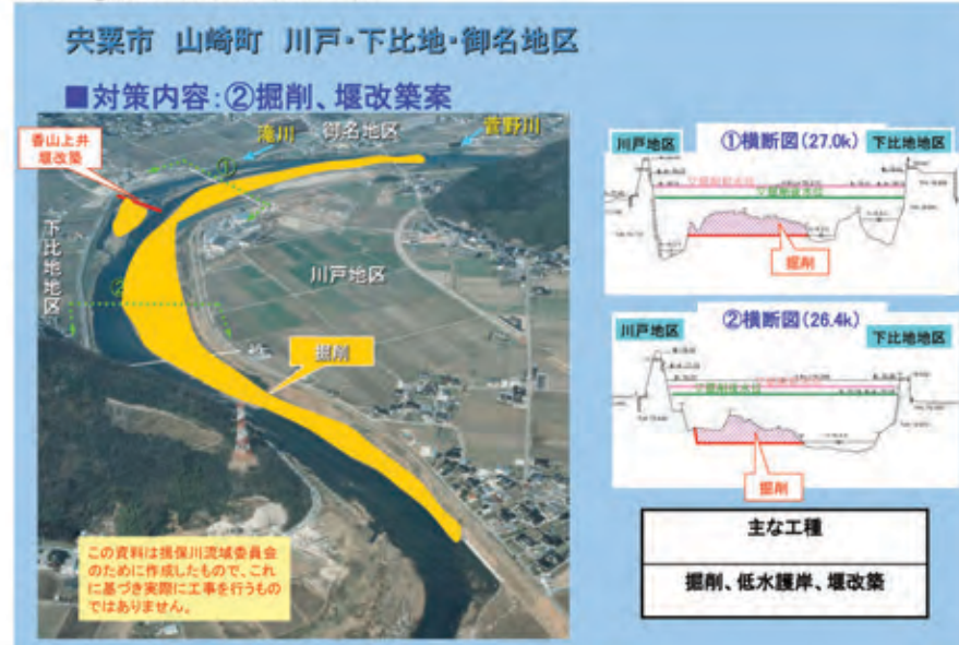
図5 ②掘削堰改築案の内容
