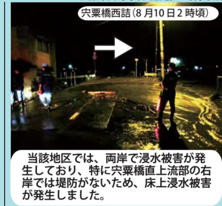
当該地区では、両岸で浸水被害が発生しており、特に宍粟橋直上流部の右岸では堤防がないため、床上浸水被害が発生しました。
