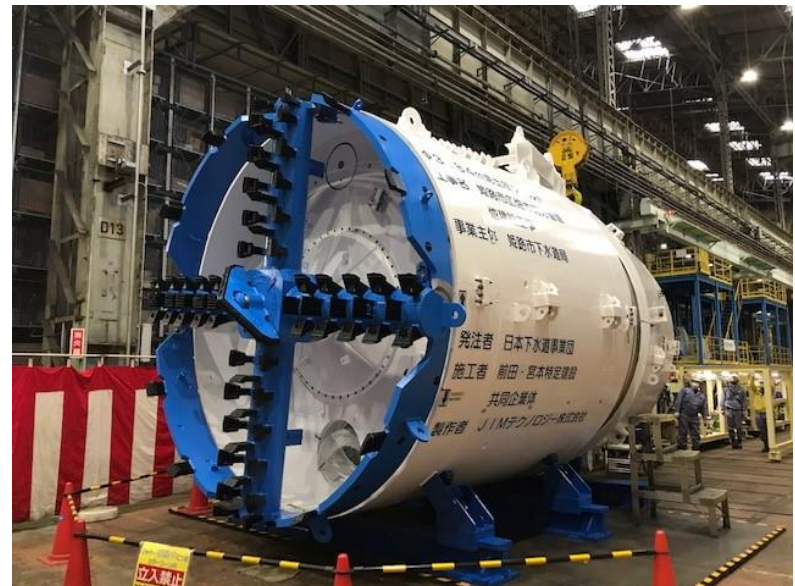
シールドマシン製作状況
