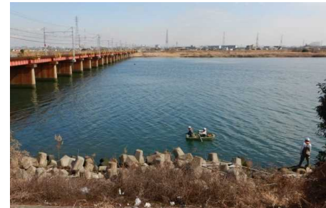
重錘法（錘を水中へ投下して深さを測定）による洗堀調査
