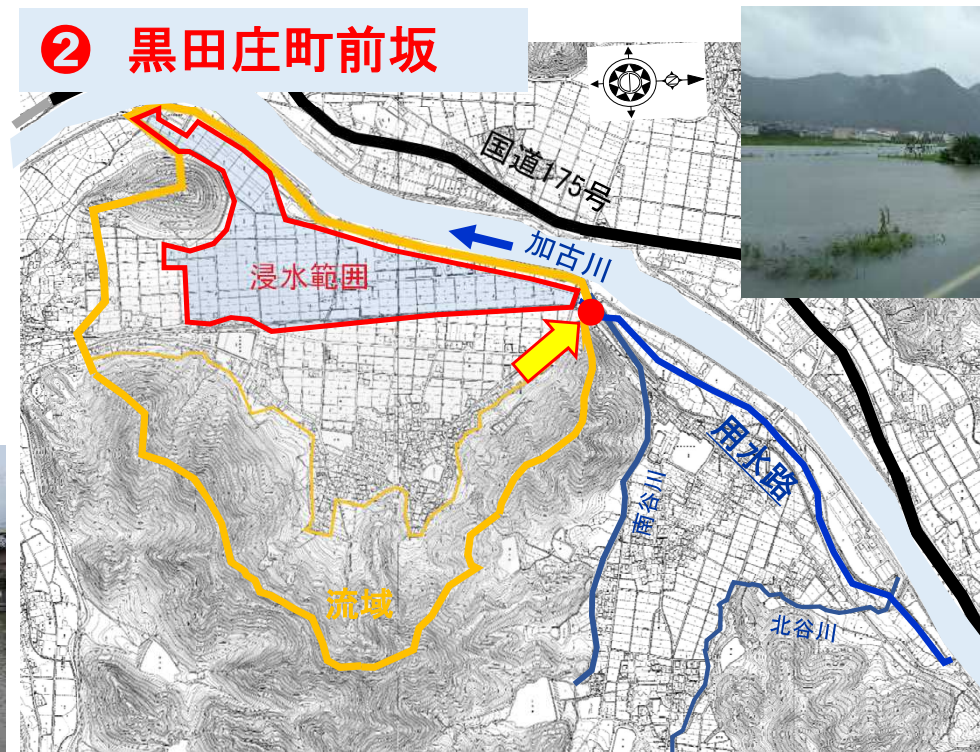
[30年7月豪雨時] 加古川の水位上昇に伴い、加古川へ排水できなくなった上流部(流域外)の雨水が用水路を伝わり流入し、浸水した
