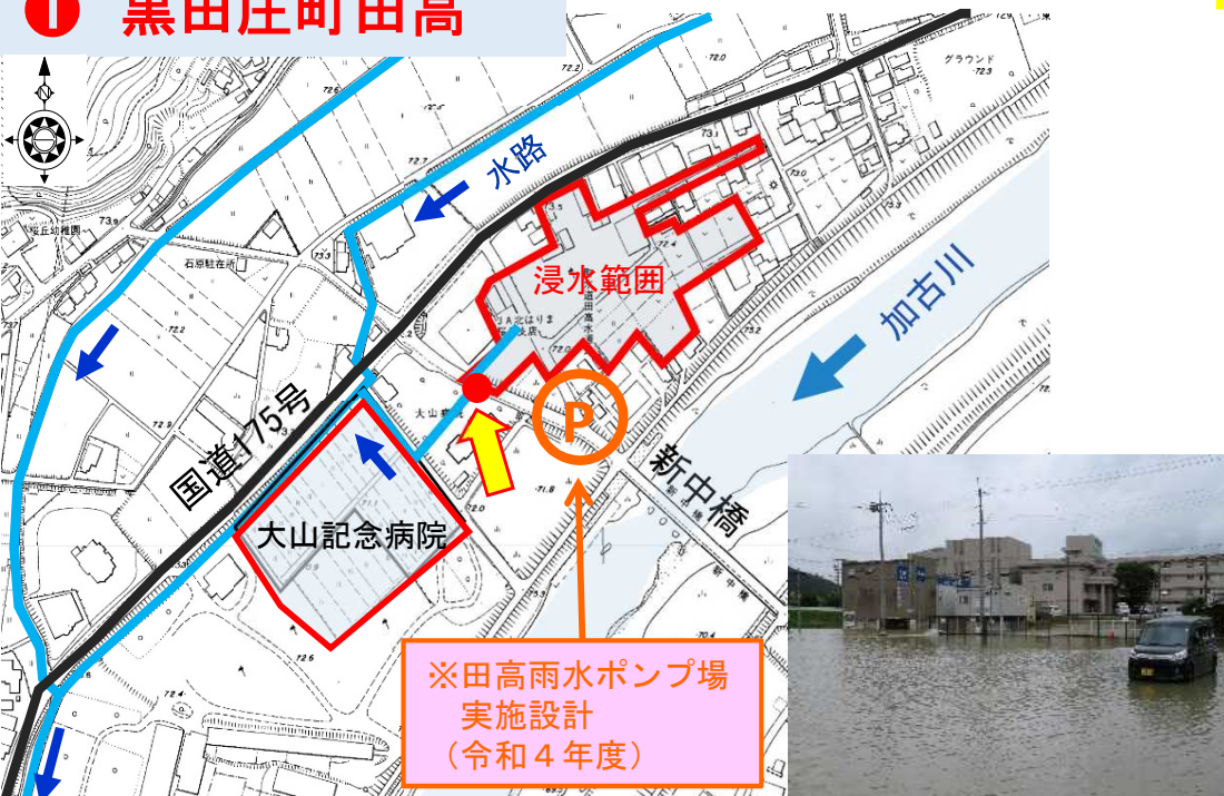
[30年7月豪雨時] 加古川の水位上昇により水路が逆流し、浸水被害が発生
