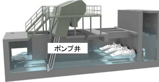
定置式ポンプ場
