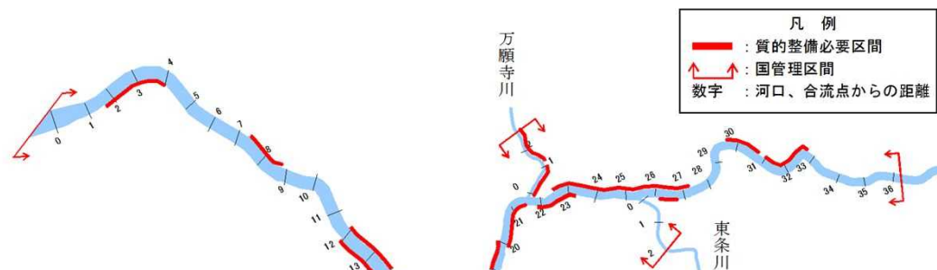
堤防の浸透対策箇所
