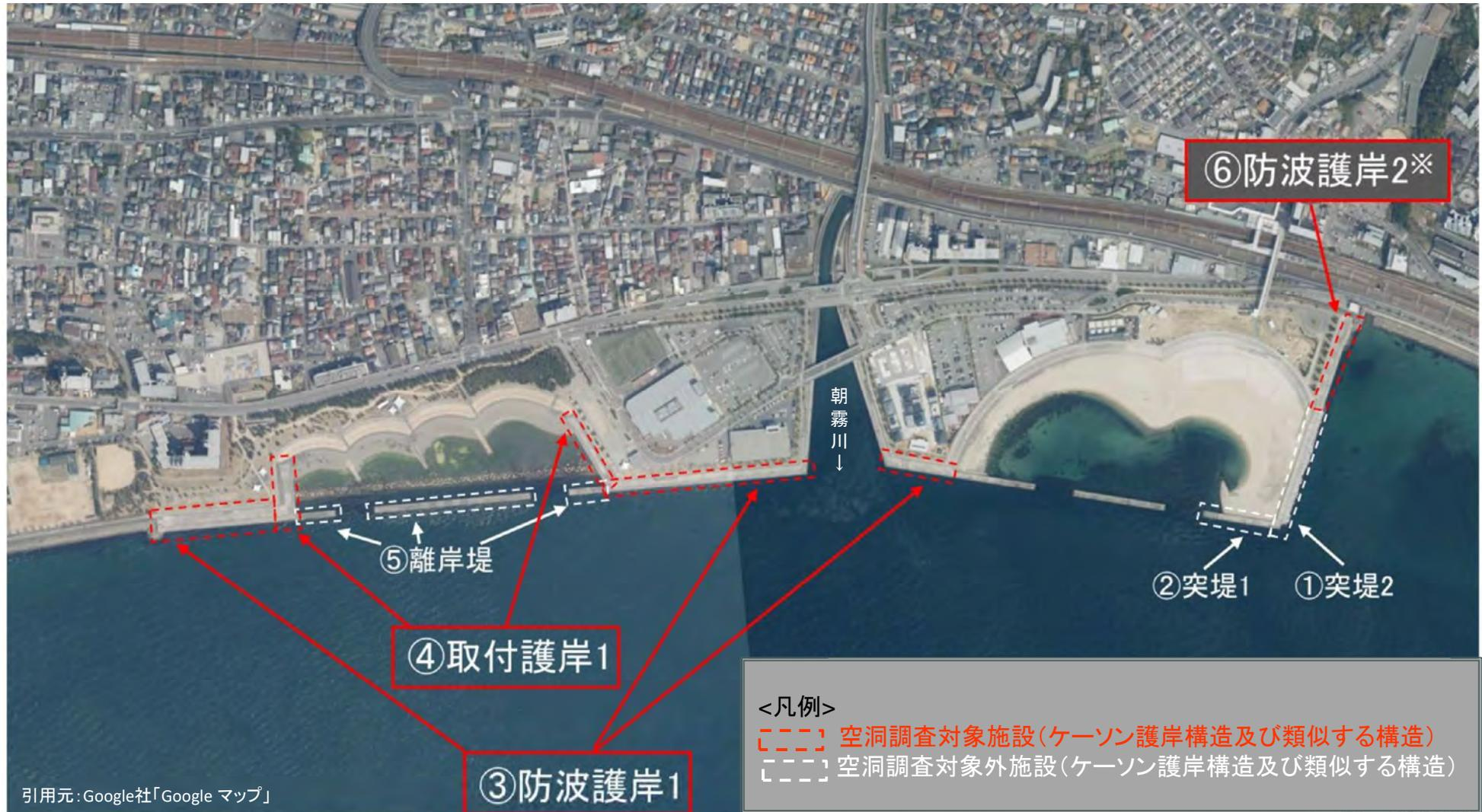
※⑥防波護岸2については、ケーソン護岸構造ではないが、直立消波ブロック構造であることから、空洞調査対象の施設とする
