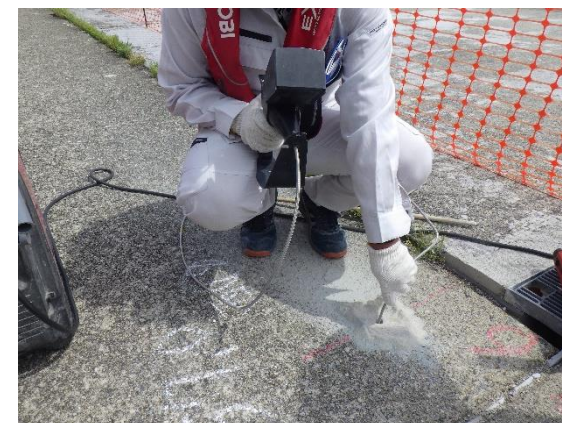
ファイバースコープカメラによる 削孔内状況の確認
