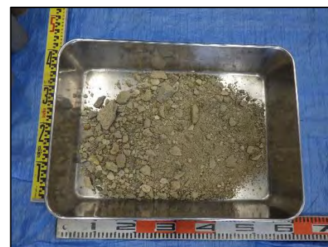
基礎碎石 上層
