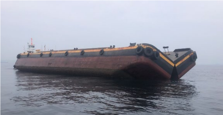
【掘削土 投入状況】
