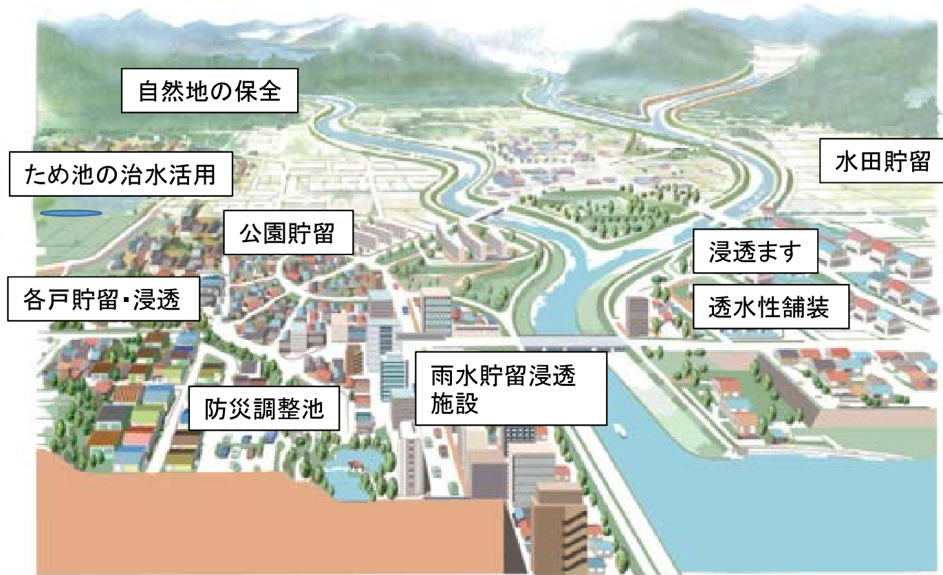
河川への流出抑制対策の例
