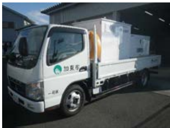
排水ポンプパッケージ車
