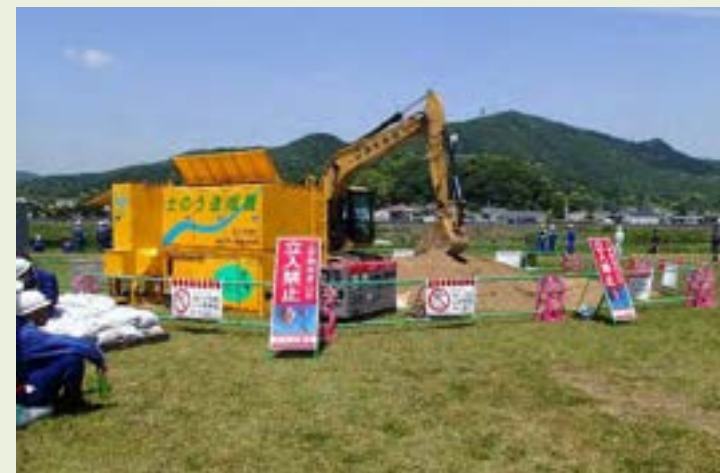
土のう造成機による土のうの製造
