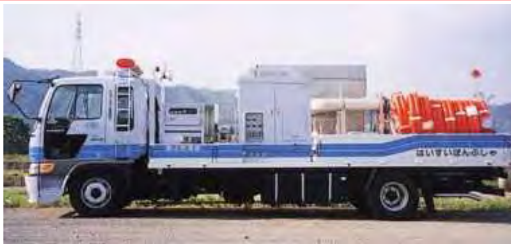
排水ポンプ車
