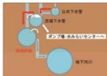
増補幹線と地下河川の関係図
