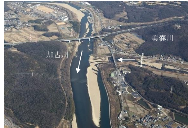
図 1.3.4 加古川と美嚢川合流地点の土砂堆積の状況(H30)
