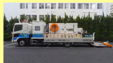
排水ポンプ車
