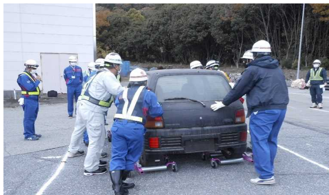
▲ 車両移動器具による移動
