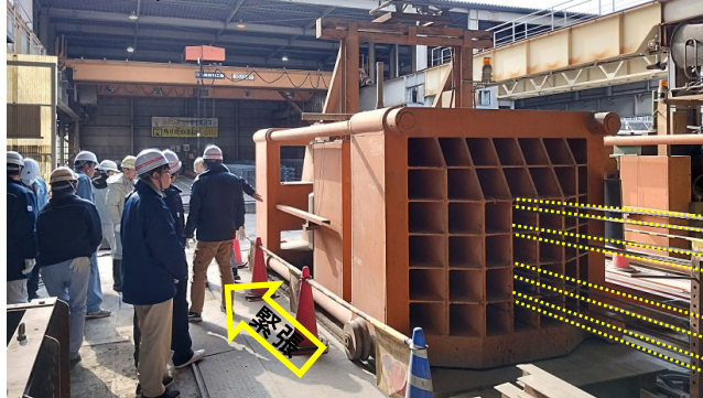
8000kNの装置でPC鋼を緊張
