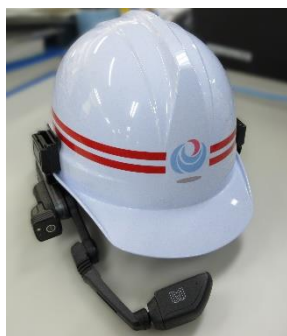
▲ヘルメットに装着したウェアラブルカメラで現場の映像を遠隔地に共有。
