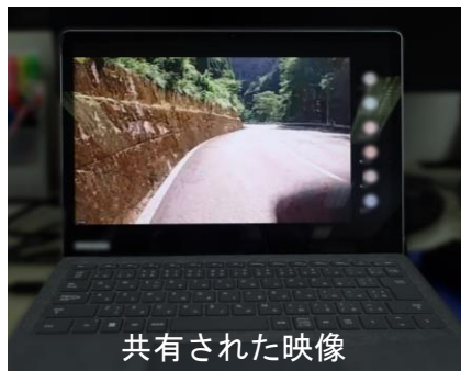
▲ヘルメットに装着したウェアラブルカメラで現場の映像を遠隔地に共有。
