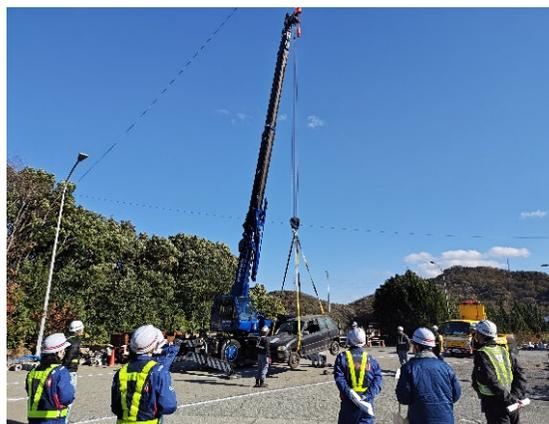
▲ 吊り下げによる車両移動
