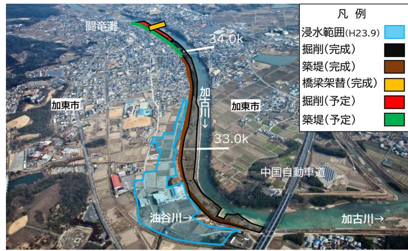
※事業実施前の平成29年河道と現況河道(令和5年度末)の河道を比較し、今次洪水が発生した際の水位を試算したもの
