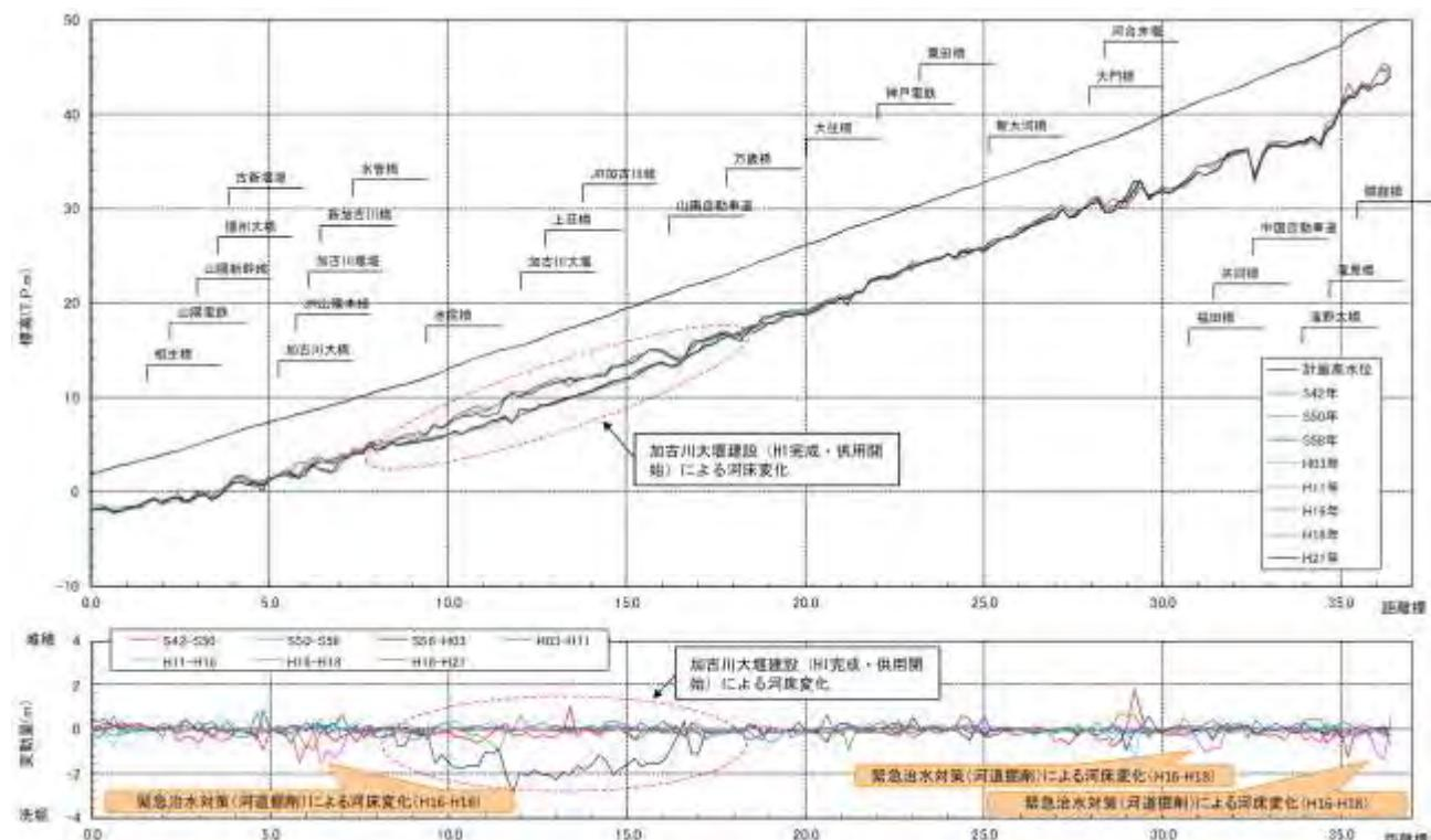
図 1.3.2 加古川平均河床高縦断図
