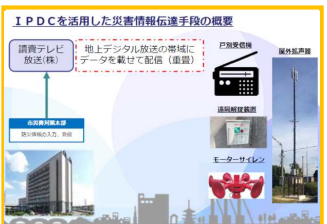
IPDC(地上デジタル放送波)を活用した防災情報の構築(加古川市)
