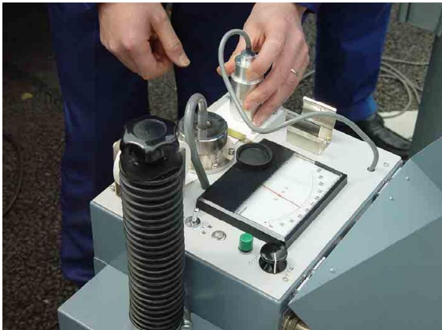
写真12 ディーゼル車の排気黒煙検査の状況（尼崎市西向島町）
