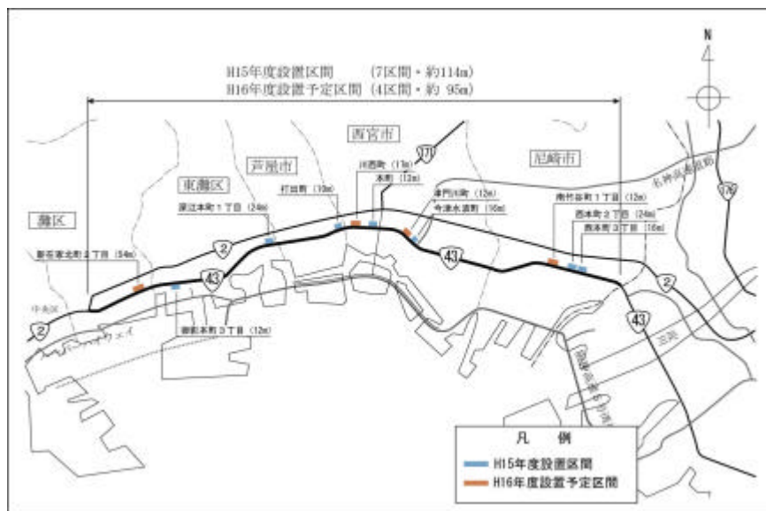
図2 遮音壁の設置箇所（平成15年度・平成16年度）
