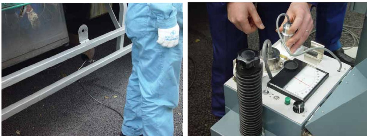
写真3. ディーゼル車の排気黒煙検査の状況（尼崎市西向島町）
