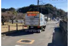
(空洞探査車による調査)
