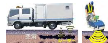
路面下空洞調査
