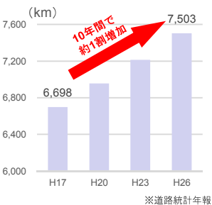
15m以上の橋梁延長の推移 (地方公共団体管理)
