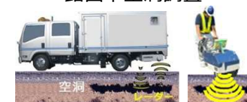
路面下空洞調査
