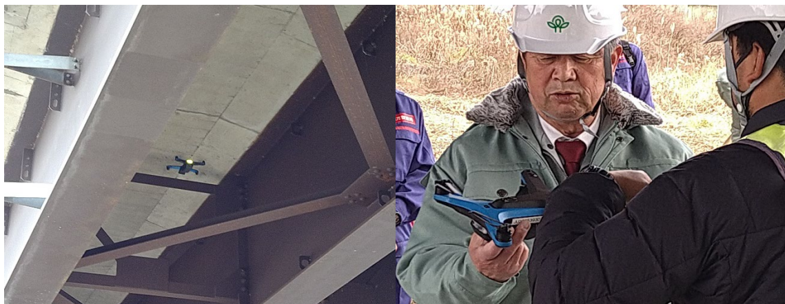
全方向衝突回避センサーを有する小型ドローン技術
