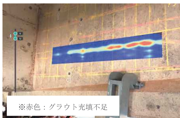
超音波探傷結果 3D 表示例（AR 表示）
