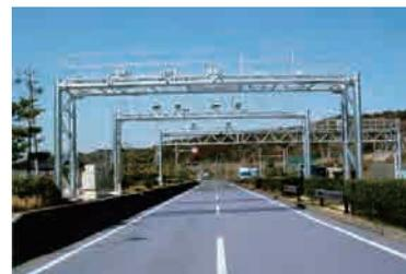
車両重量自動計測装置による計測（WIM）
