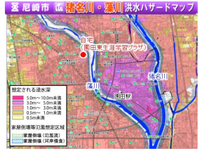
ハザードマップから浸水の深さを確認。
