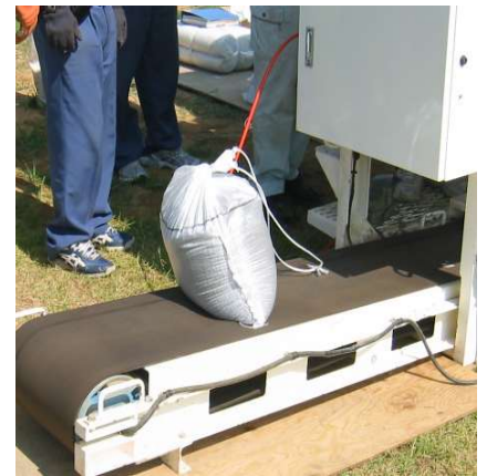
<標準的な土のう造成機による土のう作成の流れ>
