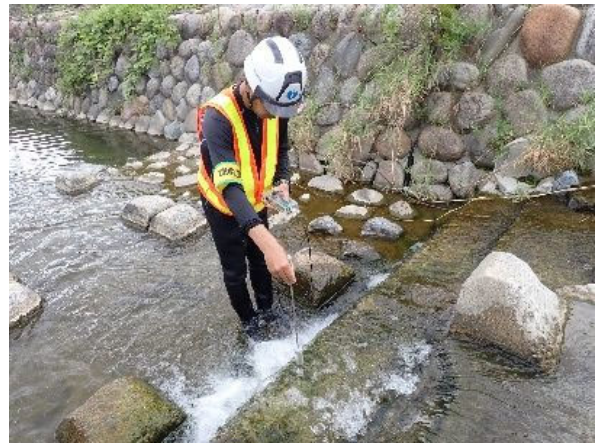
図 6.5.2 各簡易魚道内の流速の計測状況
