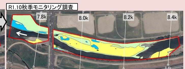
河道掘削モニタリング結果による砂州・草本等の分布図
