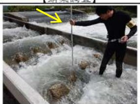
水深・流速の測定 【物理調査】
