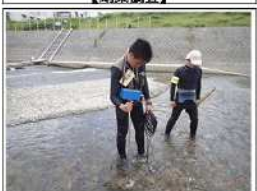
水深・流速の測定 【物理調査】
