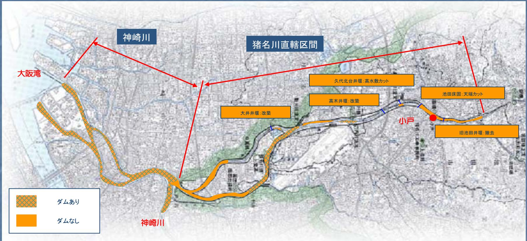
戦後最大洪水を安全に流下させるため必要な下流河川整備の事業費を、余野川ダムを建設するケースと、しないケースで比較したところ、ダム建設をしないケースが優位となった。
