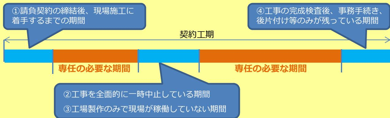
注) 工場製作の過程を含む工事の工場製作過程においても、建設工事を適正に施工するため、主任技術者又は監理技術者がこれを管理する必要があります。
