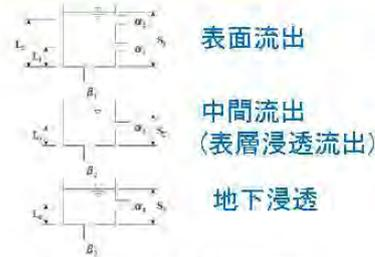
図-3 タンクモデルの模式図
