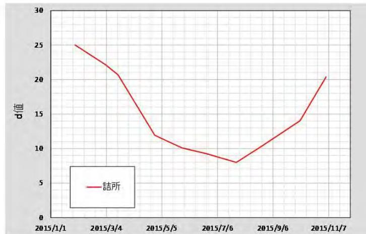
紀伊半島では、多くの地区において、降雨の安定同位体比が標高と共に低下する高度効果が認められ、手法の有効性が示された。ただし降雨の安定同位体比には大きな季節変動が見られることから、地下水・湧水の安定同位体比との絶対値の比較を行う際には、周年に渡る採水・分析を行う必要があることが示された。
