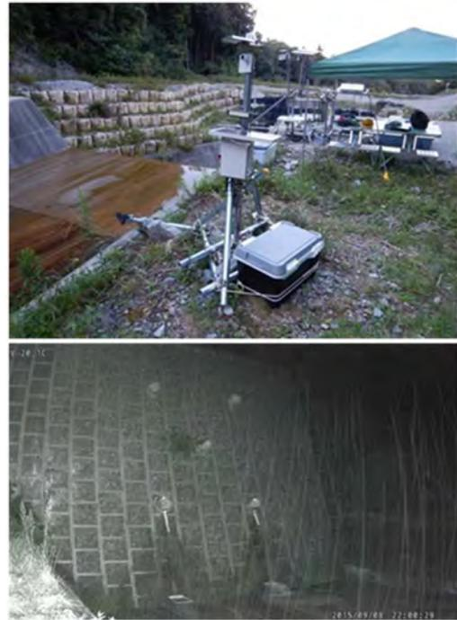
写真-8 夜間撮影が可能なLED Webカメラの導入と夜間の降雨時に撮影された画像の事例
