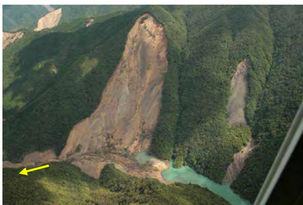
図-1 深層崩壊・河道閉塞の発生状況（赤谷地区）
