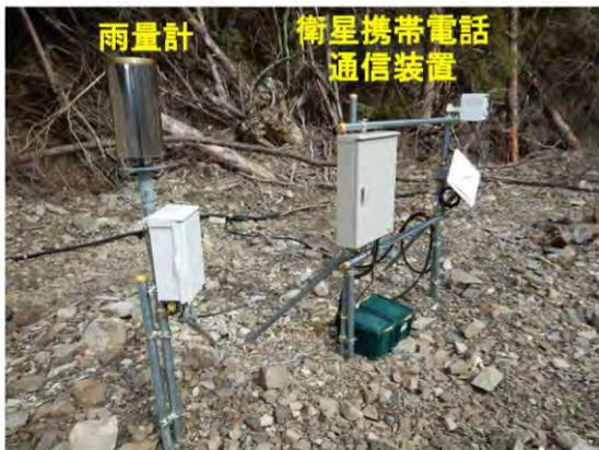
衛星携帯電話を用いた雨量観測所
