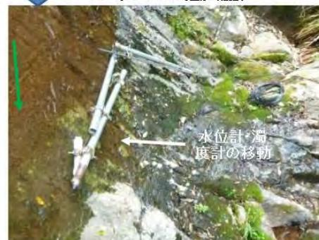
水位計・濁度計の移動(9/28)
