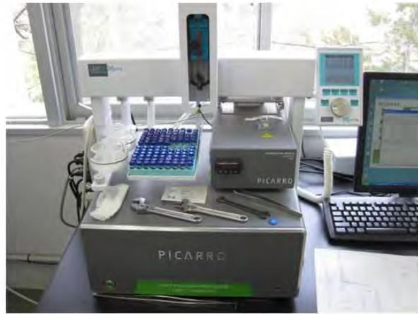
波長可変半導体レーザー吸収
