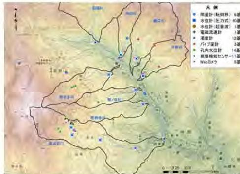
図 観測機器設置状況(那智川流域土砂動態観測システム)
