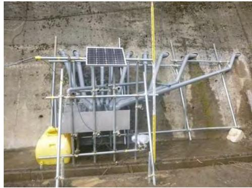
写真-1 横ボーリング工排水量観測装置
