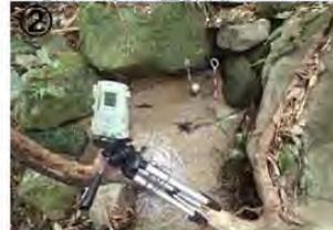
湧水の湧出箇所に水質計を設置
